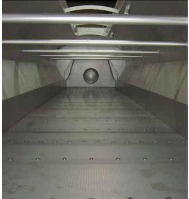
**Schwing-Fließbett-Einheiten** für die kontinuierliche Verarbeitung von klebenden Produkten bei einer breiten Partikelgrößenverteilung.
