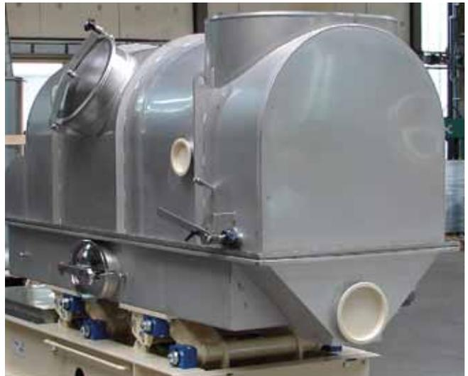
**Statische Fließbetteinheiten** in kontinuierlicher oder diskontinuierlicher Bauweise für gleichmäßige Produkte die nicht zur Agglomeration neigen.
