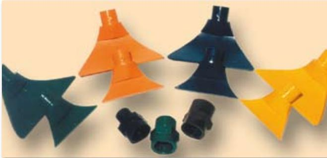
**Aquaplast-Fächerdüsen**, aus Polyurethan sind verschleiß- und korrosionsfest, weitgehend verstopfungsfrei, auch bei Partikeln bis zu 3 mm im Brausewasser, hervorragend bewährt bei Waschvorgängen auf Siebmaschinen, mit einem gleichmäßigen, fächerförmigen Wasserschleier bei Drucken von 0,5 bis 3,5 bar.
