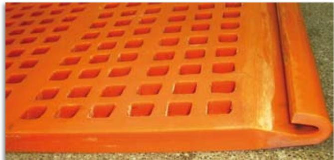
**Ausführung** : Siebböden mit eingegossenen Sieböffnungen in konventioneller Ausführung 35, 63, 85 Shore-A-Härte.
