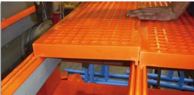
**UNI 2000 - System-Siebböden** werden mit Hilfe von Adapterleisten auf der Unterkonstruktion befestigt. Hierdurch ist dieses System kompatibel zu anderen Siebsystemen.
